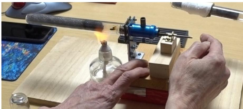
加熱が進んだ頃にピストンを軽く押し込むと自励振動が始まる
