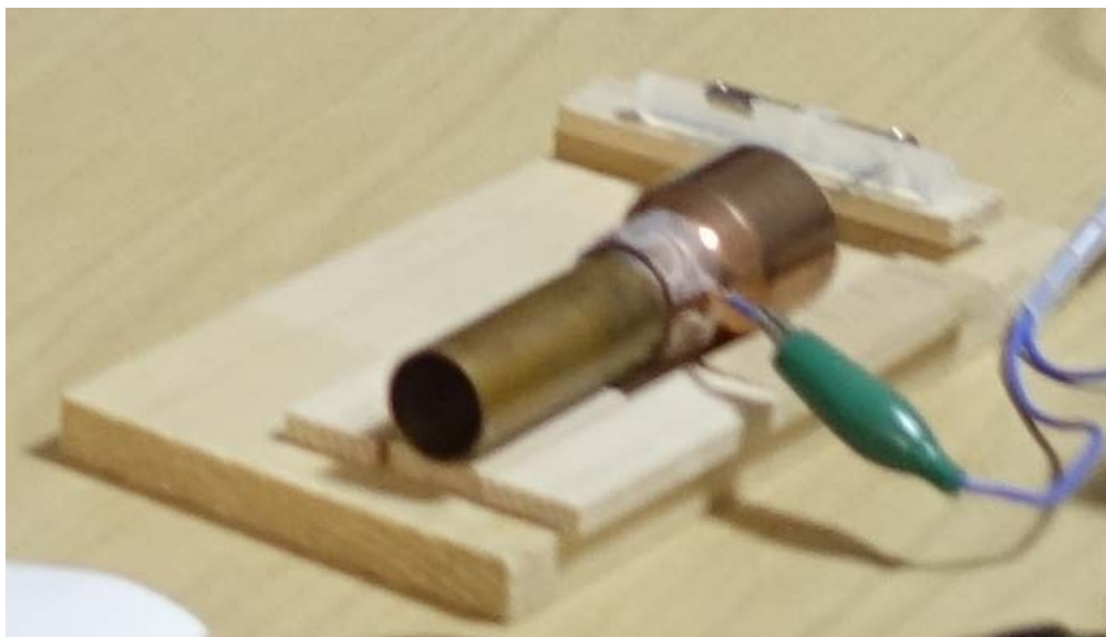
イオン風実験機 (20KV 80 \mu A)
