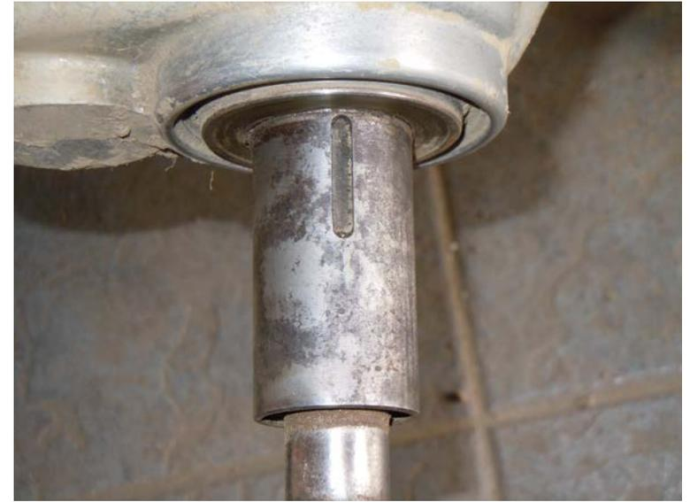
回転軸キー溝にキーを入れて、ホルダー溝にキーを合わせて、挿入する。
