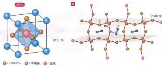
図2 有機無機ハイブリッドのペロブスカイト結晶の構造
