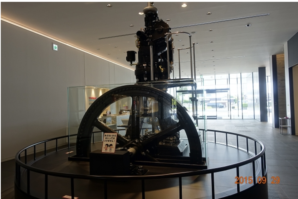
1899 年製世界初最古のディーゼル・エンジンのレプリカ出力 20hp
