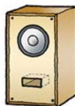
フロントダクト
