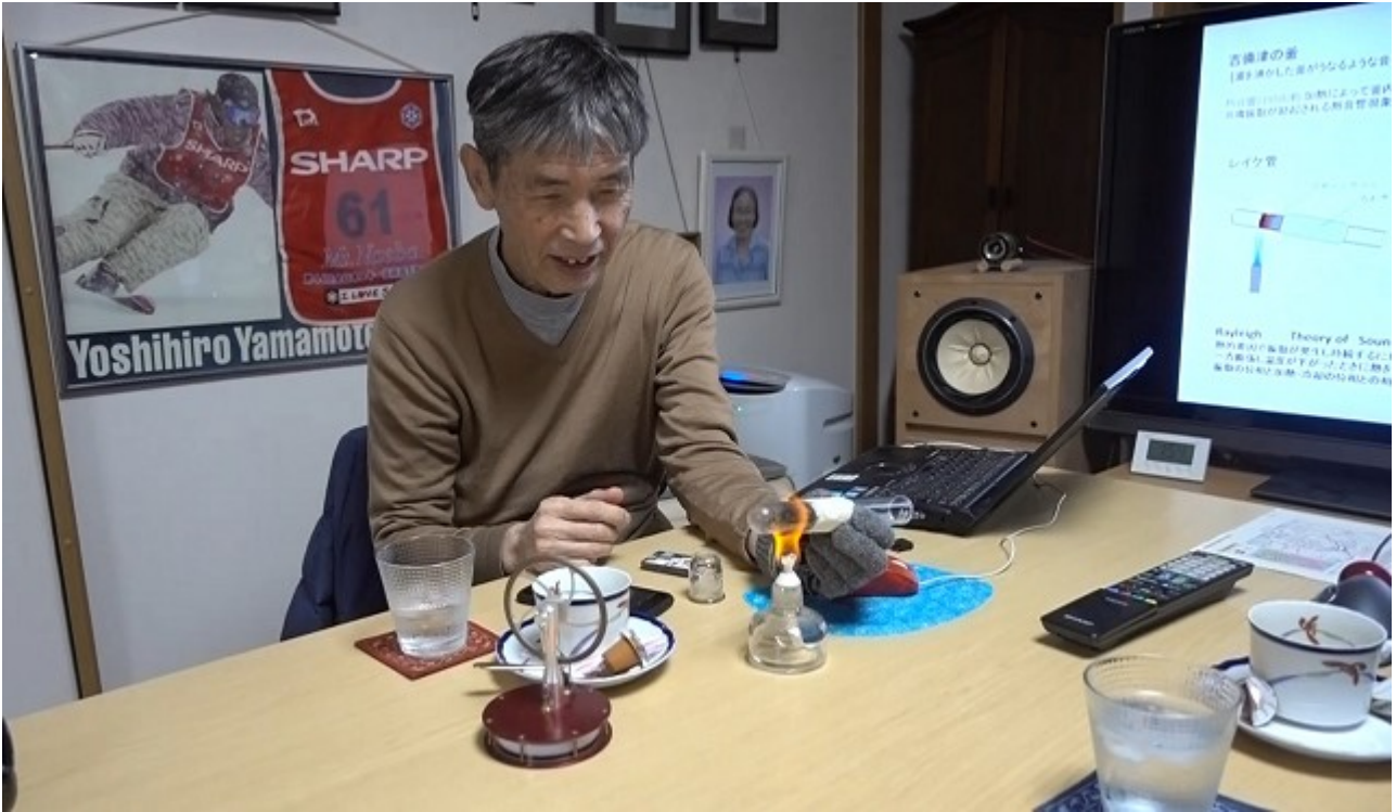
西村さん 手作りデバイスでの熱音響実験
