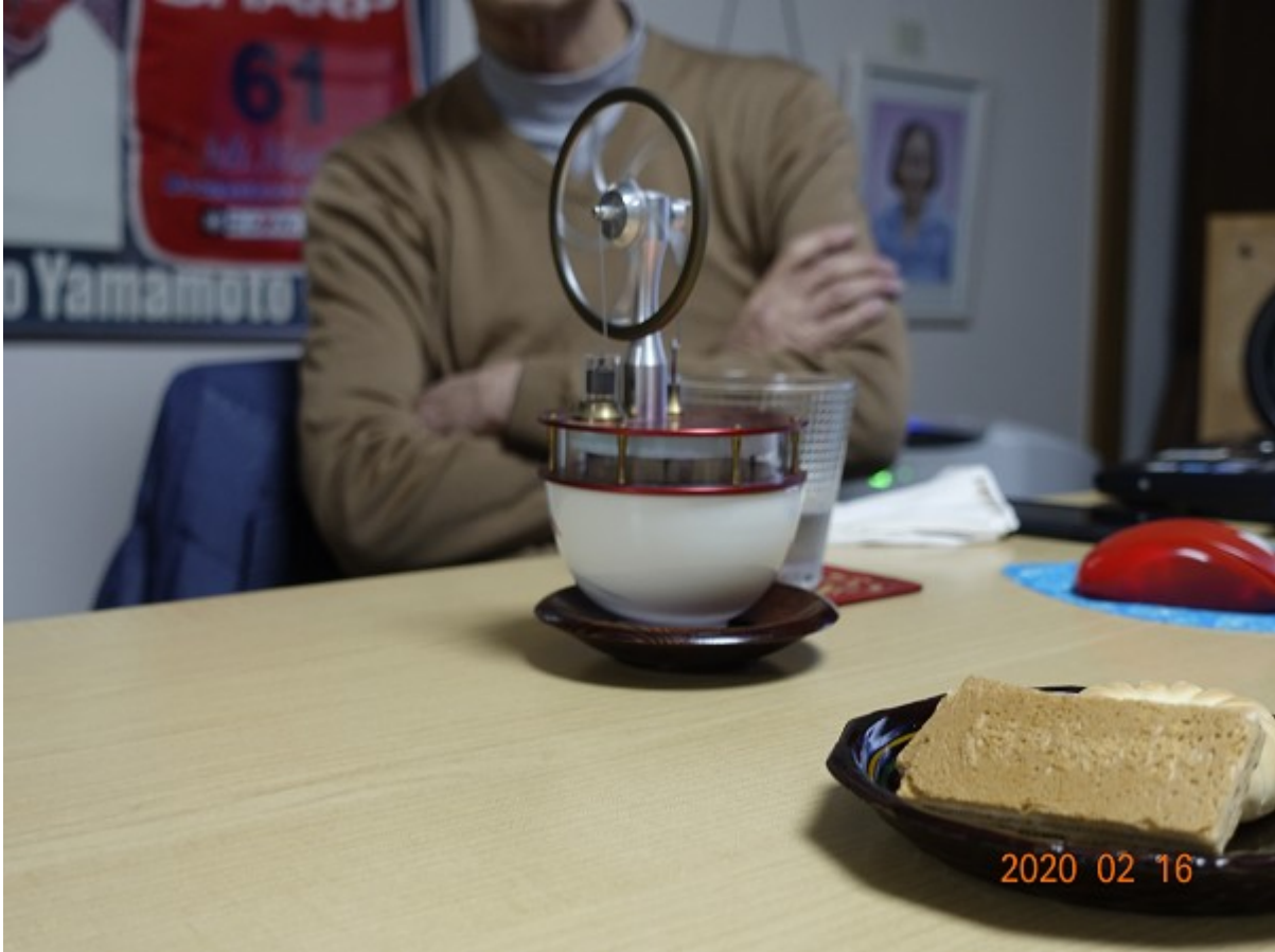
暖かいお茶の入った湯呑のうえで回転するスターリングエンジン模型
