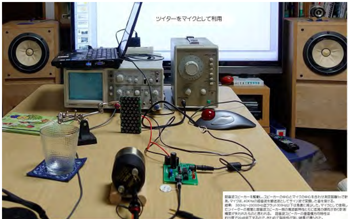
超音波スピーカーはムラタ製のピエゾ型センサー50個を流用
